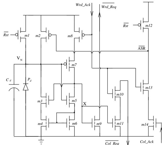
Fig. 1. Pixel Schematic
