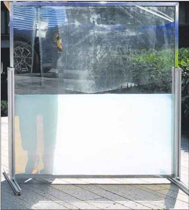
由液态夹层玻璃制作出的窗户在气温上升时会自动逐渐变得不透明，阻挡阳光，气温下降后会变回透明清晰。（南洋理工大学提供）
