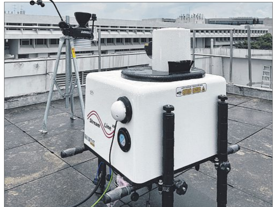
南大新加坡地球与观测研究所去年9月，在南大校园里的一栋大楼屋顶上，安装全新的监测系统，可实时监测距离地面3000公尺的大气层，并测量空气中的雾霾和风向。（南大提供）
