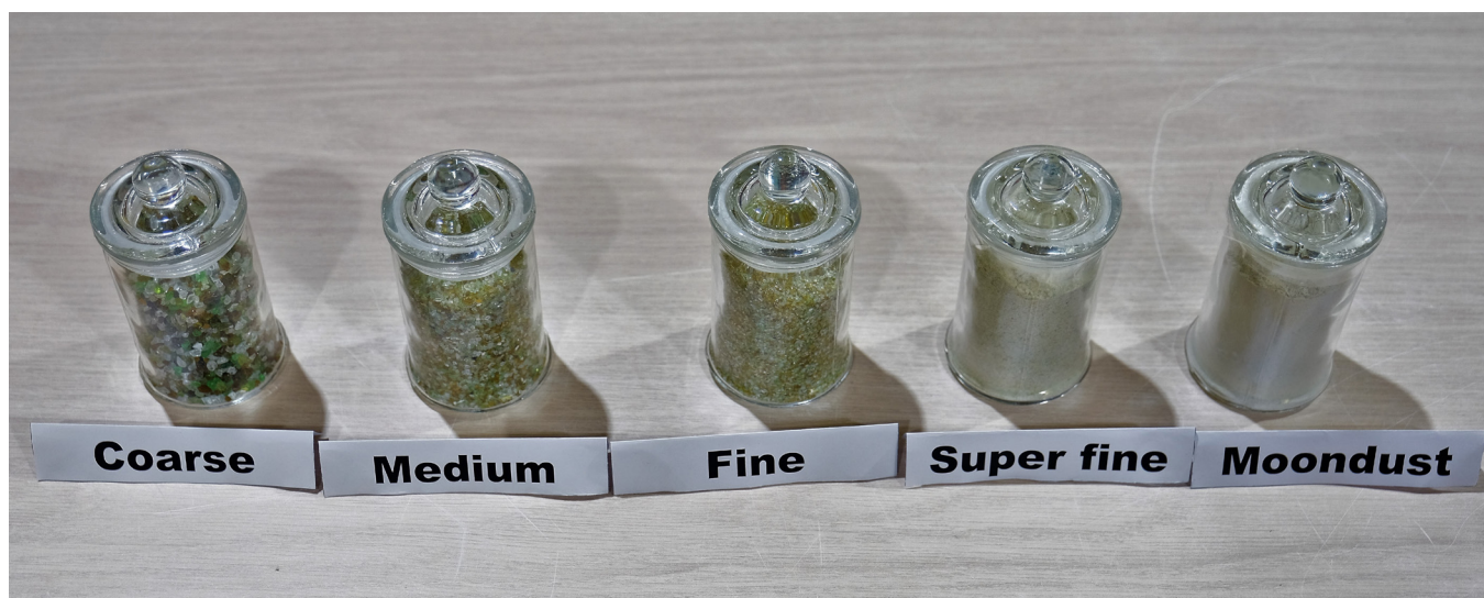
Fot. 1. Szkło z recyklingu do drukowania 3D rozdrobione na ziarna o różnych rozmiarach; od lewej do prawej: zgrubne, średnie, drobne, super drobne, pyliste
