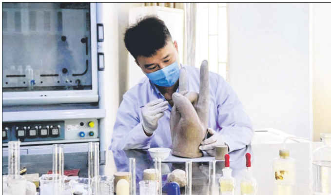
曾在南洋理工大学城市对策中心担任副研究员的杨阳博士研究了生物水泥生产工序的创新，图为他使用生物水泥修补来自中国重庆世界文化遗产大足石刻的佛手。（南洋理工大学提供）
