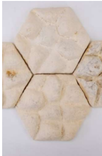
Sechseckige Fliesen: Wärmeschutz nach dem Vorbild der Elefantenhaut (Foto: ntu.edu.sg)
