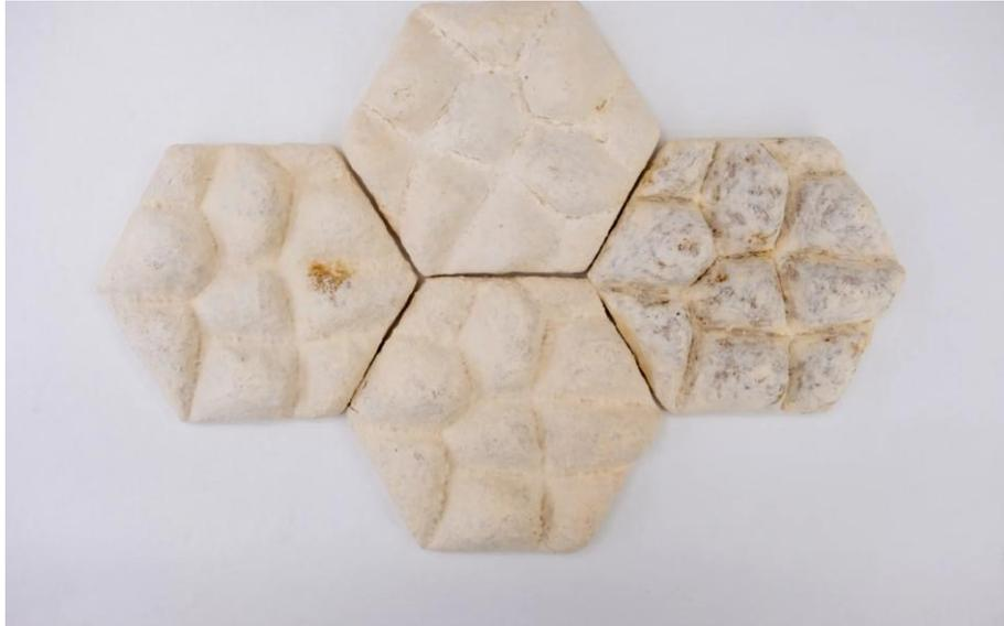
由新加坡南洋理工大学 (NTU Singapore) 领导的科学家发明了一种所谓的“真菌瓷砖”，旨在被动冷却建筑物并抵御热带气候下的暴雨等环境力量。
