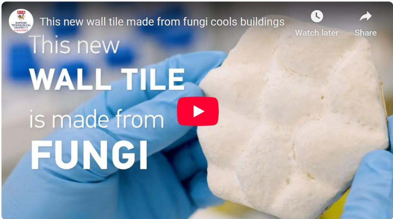
I primi test hanno dimostrato che la **velocità di raffreddamento delle piastrelle è migliore del 25%** rispetto a piastrelle realizzate in micelio ma con superficie liscia; allo stesso modo la **velocità di riscaldamento è inferiore del 2%**.
