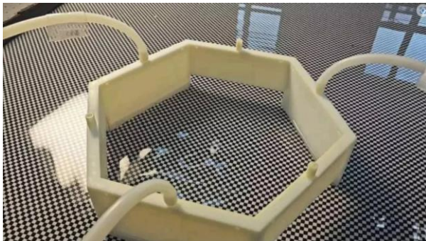
实验中用于产生波的结构。
