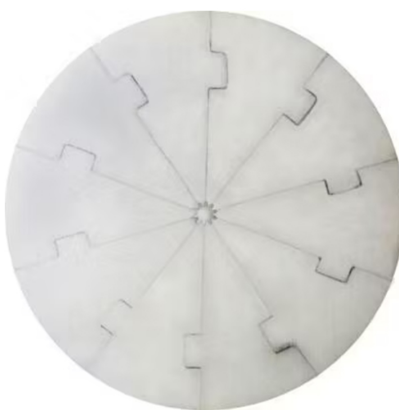
制作微流控芯片的每个部件都有企口，也就是一侧有凹槽，另一侧有凸榫，结合时可以精准对齐。（南洋理工大学提供）
