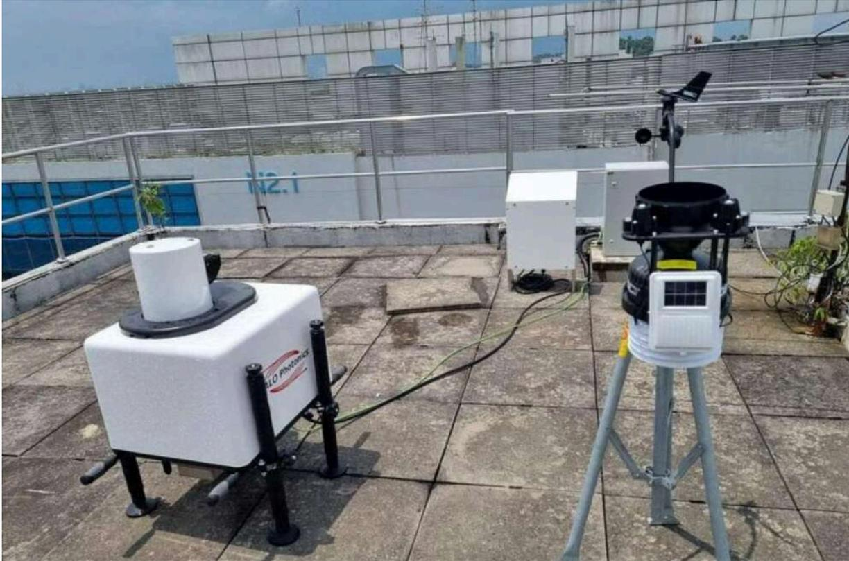
南大新加坡地球与观测研究所（Earth Observatory of Singapore, 简称EOS）去年9月，在南大校园里的一栋大楼屋顶上，安装全新的监测系统，可实时监测距离地面3000公尺的大气层，并测量空气中的雾霾和风向。
