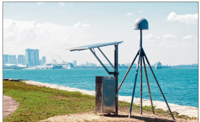
南洋理工大学首个卫星导航系统数据收集站正式启动，数据站位于拉扎鲁斯岛，它将持续追踪新加坡周围土地高度和海平面变化。
