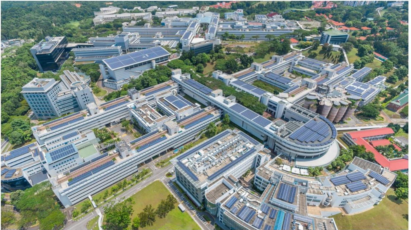
南洋理工大学投资570万元，在校园里装置1万3000多个太阳能光伏板，使校园内的太阳能发电量增加超过74%。（图：南洋理工大学）
