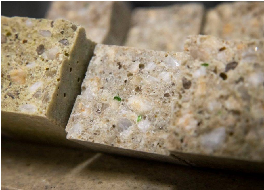
▲Deakin 大学的玻璃基聚合物混凝土，图片来自：Deakin University
