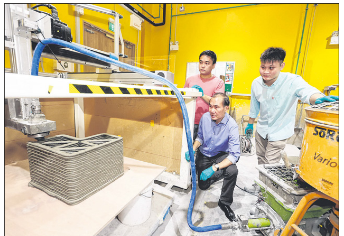
南大电机与电子工程学院研究员郑奕威（左起）、机械与宇航工程学院教授陈明任与南大新加坡3D打印研究中心研究员陈元亨，展示用玻璃碎片代替沙子3D打印而成的40厘米高L形混凝土长凳。这种新型混凝土的养护（curing）只需约一个月，比传统混凝土短两个月，日后若应用于建筑业料将缩短工期。（邱启聪摄）
