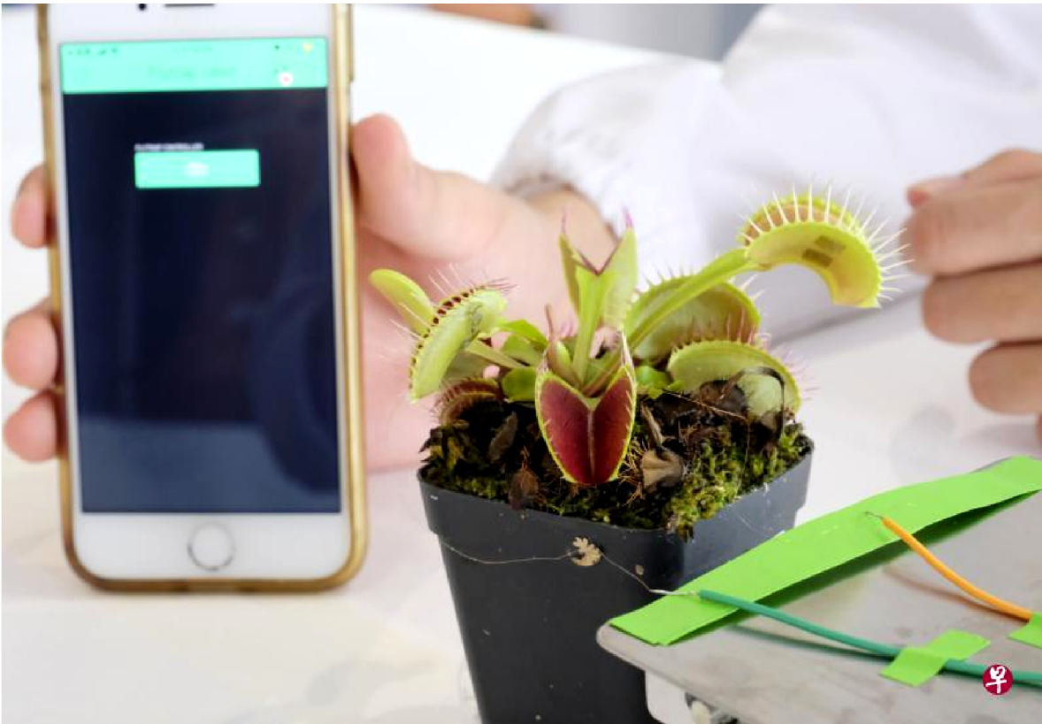
研究员通过智能手机传递或接收电信号，从而控制捕蝇草的动态或监测捕蝇草的状态。（南洋理工大学提供）
