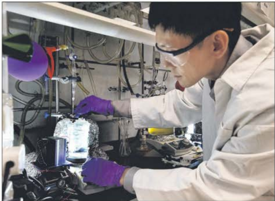
苏汉昇助理教授示范如何进行这项研究，将化学剂放在LED灯下持续六天照射后，就可产生甲酸。（梁伟康摄）
