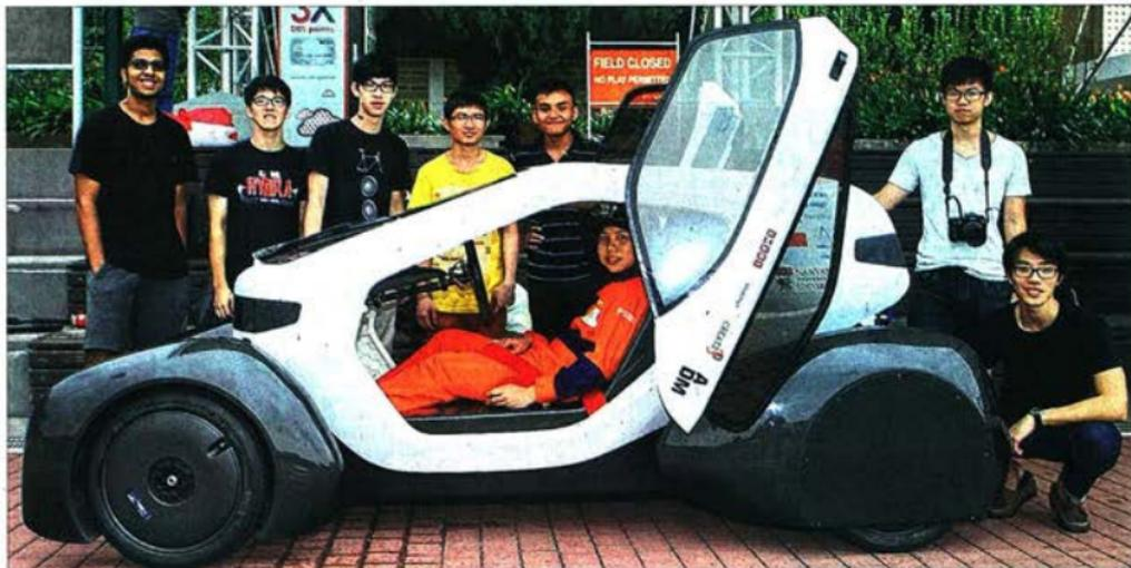
由八名南大生设计和制造的NV8四轮概念车，白色塑料车身是利用三维打印技术印制，深灰色底盘则用碳纤维以模子铸型制成。
