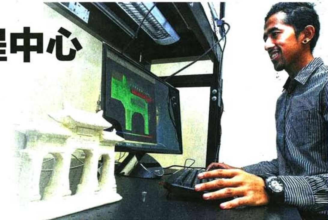
研究人员用一台采用光学技术的三维摄像机扫描模型，可准确地测量出模型的各个部件尺寸。（陈斌勤摄）
