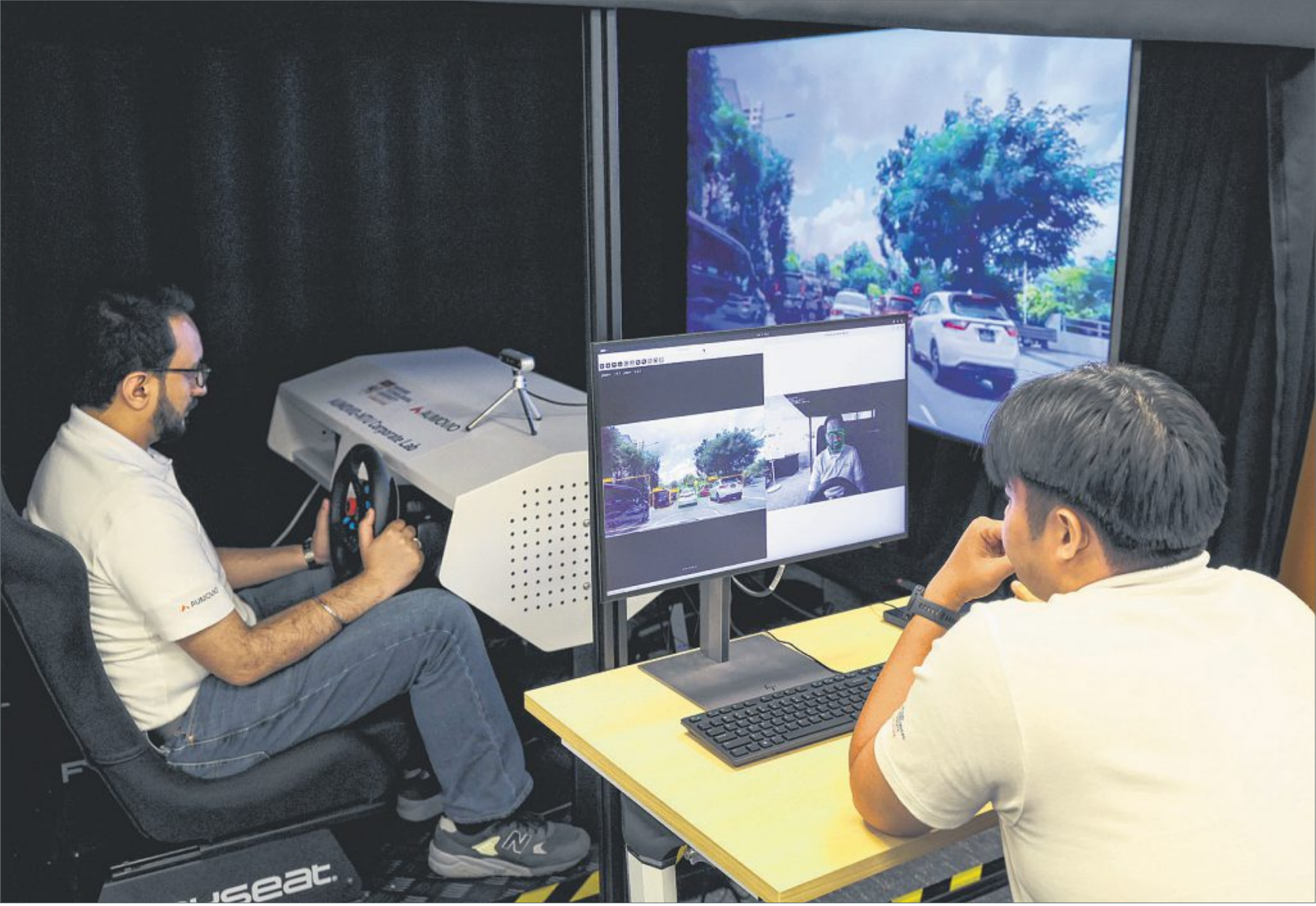
南洋理工大学与德国科技公司Aumovio合作的企业实验室未来三年会研发出智能汽车科技方案，包括这套以人工智能驱动的系统。系统一方面通过摄像头和传感器分析路面情况，另一方面则通过车内摄像头观察司机状态，及时发出提醒。（张俊杰摄）
