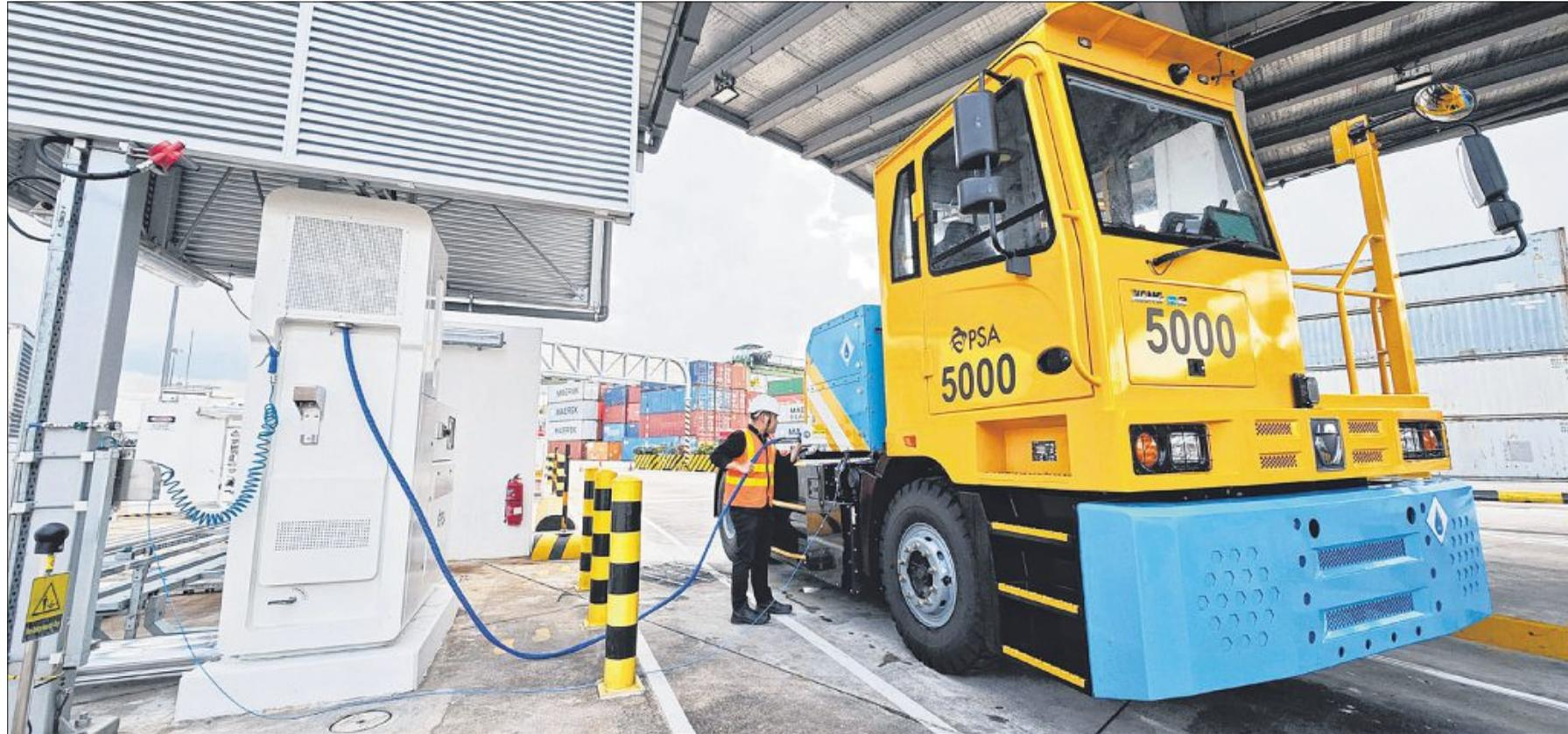
为配合联合测试，港务集团在巴西班让码头建造、运作和维护一座加氢设施，当中包括加氢站、氢储存罐和压缩机等。图为员工在码头的加氢站为电动拖车注入氢燃料。（新加坡港务集团提供）
