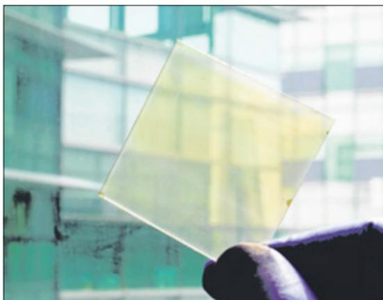
南大研究人员研发出的节能玻璃，具备利用两种自然光加热或冷却的性能。(南大提供)
