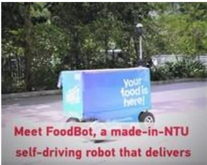
フードボットは4輪のついた電動ロボット。時速5キロメートルで走行する。積載量は50キログラム。現在は5台が運用されている。
