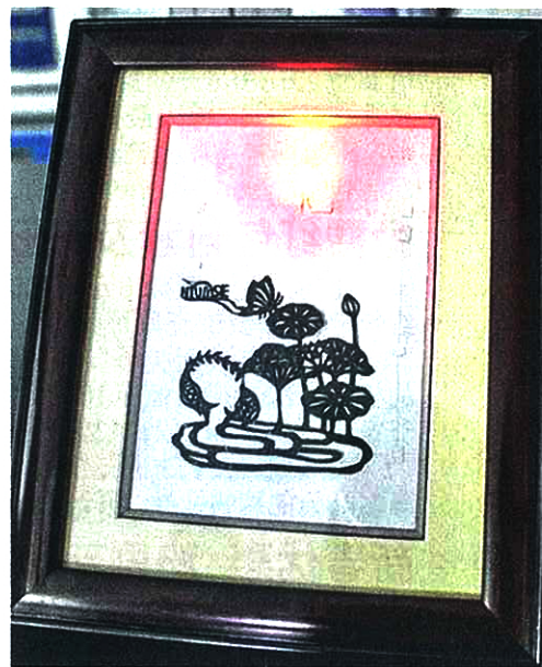
▲科研人员将超级电容器件剪成一幅莲花图，不论剪裁成任何形状，储能器件还是能够驱动LED灯。（南大提供）
