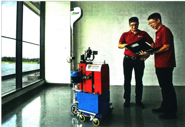
这台造价不菲的机器人，有助建筑业者更快检查新建筑物是否出现裂纹或凹凸不平等问题。（李天铸摄）
