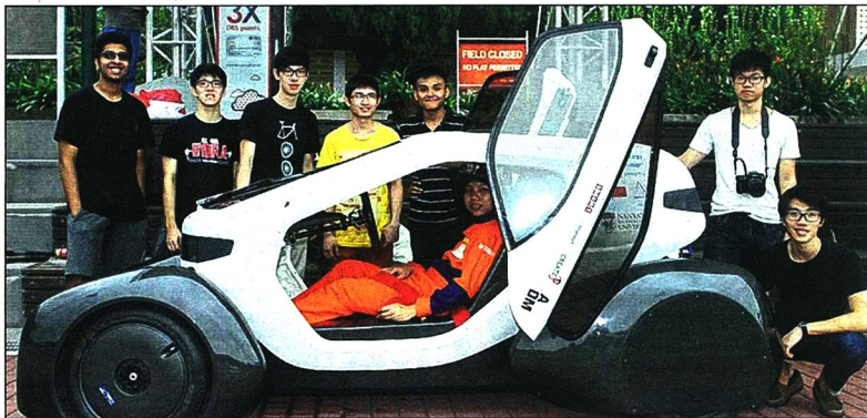
由8名南大生设计和制造的NV8四轮概念车，白色塑料车身是利用三维打印技术印制，深灰色底盘则用碳纤维以模子铸型制成。(谢智扬摄)
