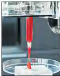
打印机可打印模拟血管的结构，让血管细胞在其中生长。
